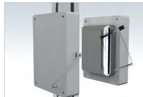
1. IML PolyTC® Label einlegen Das PolyTC® Label wird in das Spritzgießwerkzeug (feste Seite) eingelegt.
