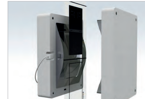
2. IMD Folienpositionierung Die IMD-Folie wird mittels Folienvorschubgerät im Rolle-zu-Rolle-Prozess positioniert.
